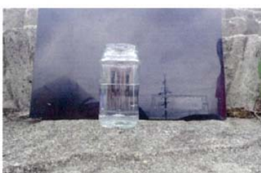
採水(濁度 臭気調査)
