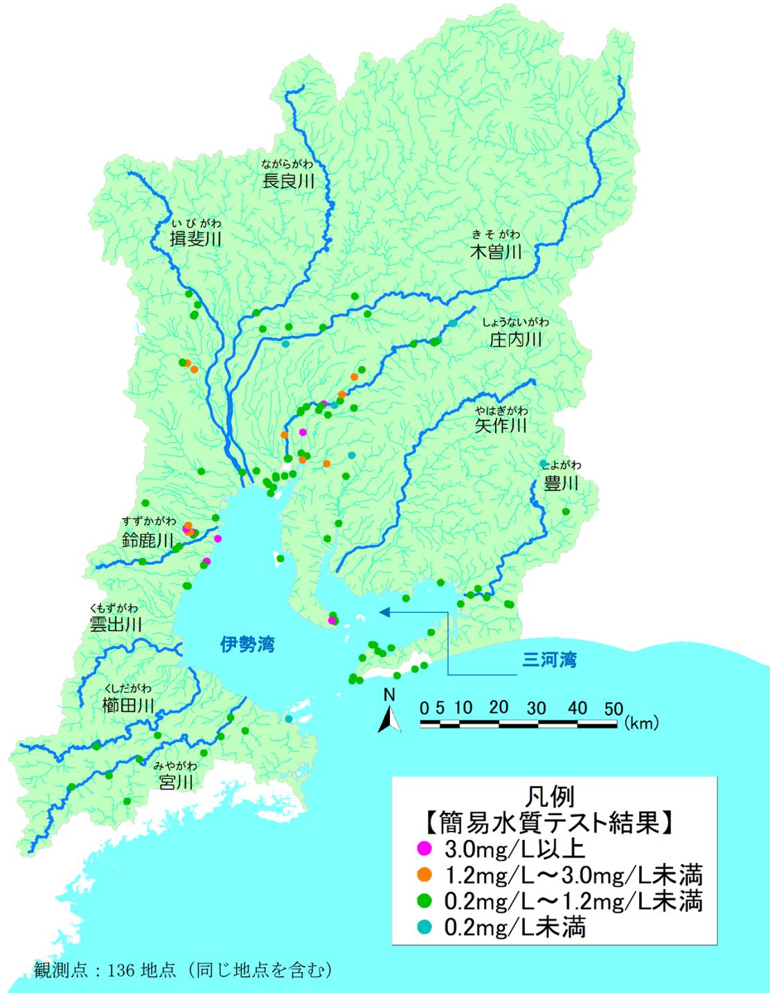
図 4.12 NO<sub>3</sub><sup>-</sup>-N(簡易水質テスト結果)
