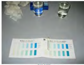
IMG_0477 2013/08/13 11:48:43 アンモニウム態窒素 0.2mg/L
