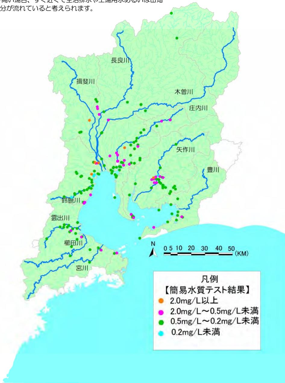
図 17 NH<sub>4</sub>(簡易水質テスト結果)
