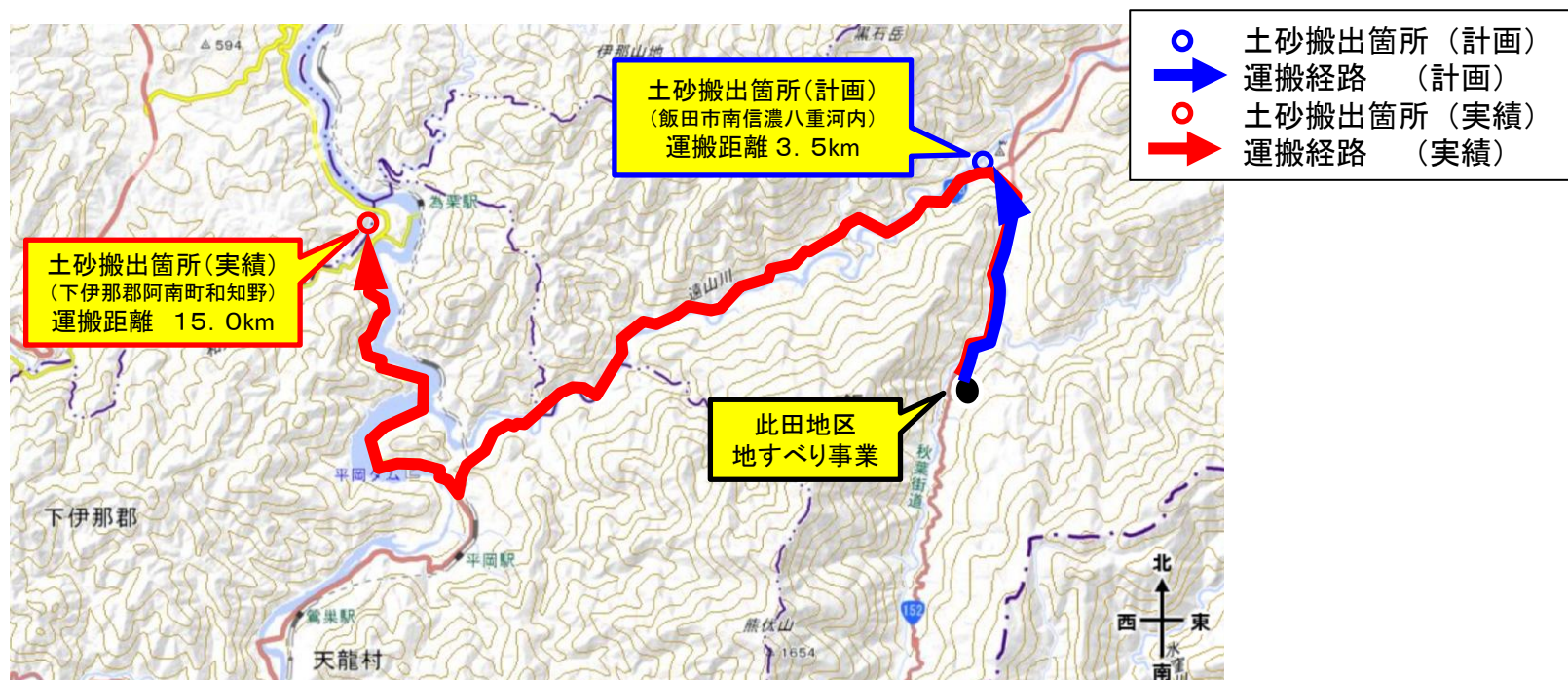
土砂搬出箇所と運搬経路の変更
