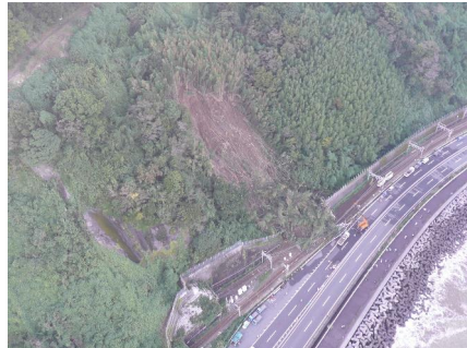
図2-1-2 興津東町での表層崩壊状況 (H26.10)
