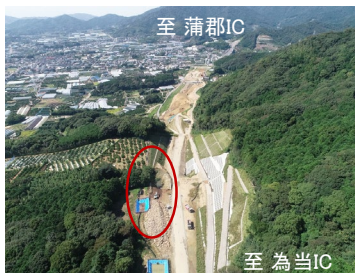
岩破碎ヤード位置 ※粉塵・騒音の影響に配慮した位置に設置
