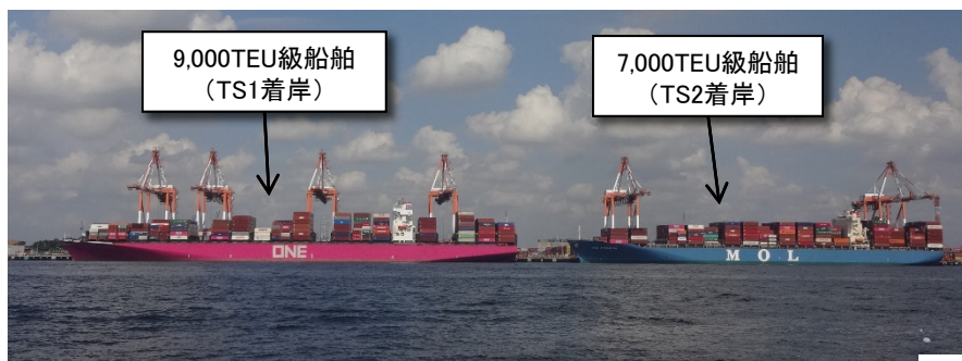
《飛島南側ターミナルにおける大型船二隻同時着岸の事例》
