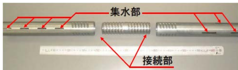
恒久集排水ボーリング保孔管
