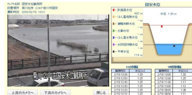
CCTVカメラ等による河川状況の監視
