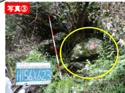
最大径1.0mの浮石. H25防災点検結果
