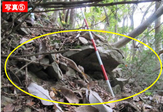
中腹部以高は砂岩の浮石が各所に点在。H23防災点検結果
