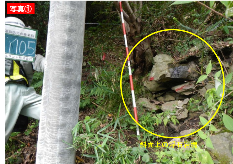
径30~50cm程度の浮石岩塊. H25防災点検結果
