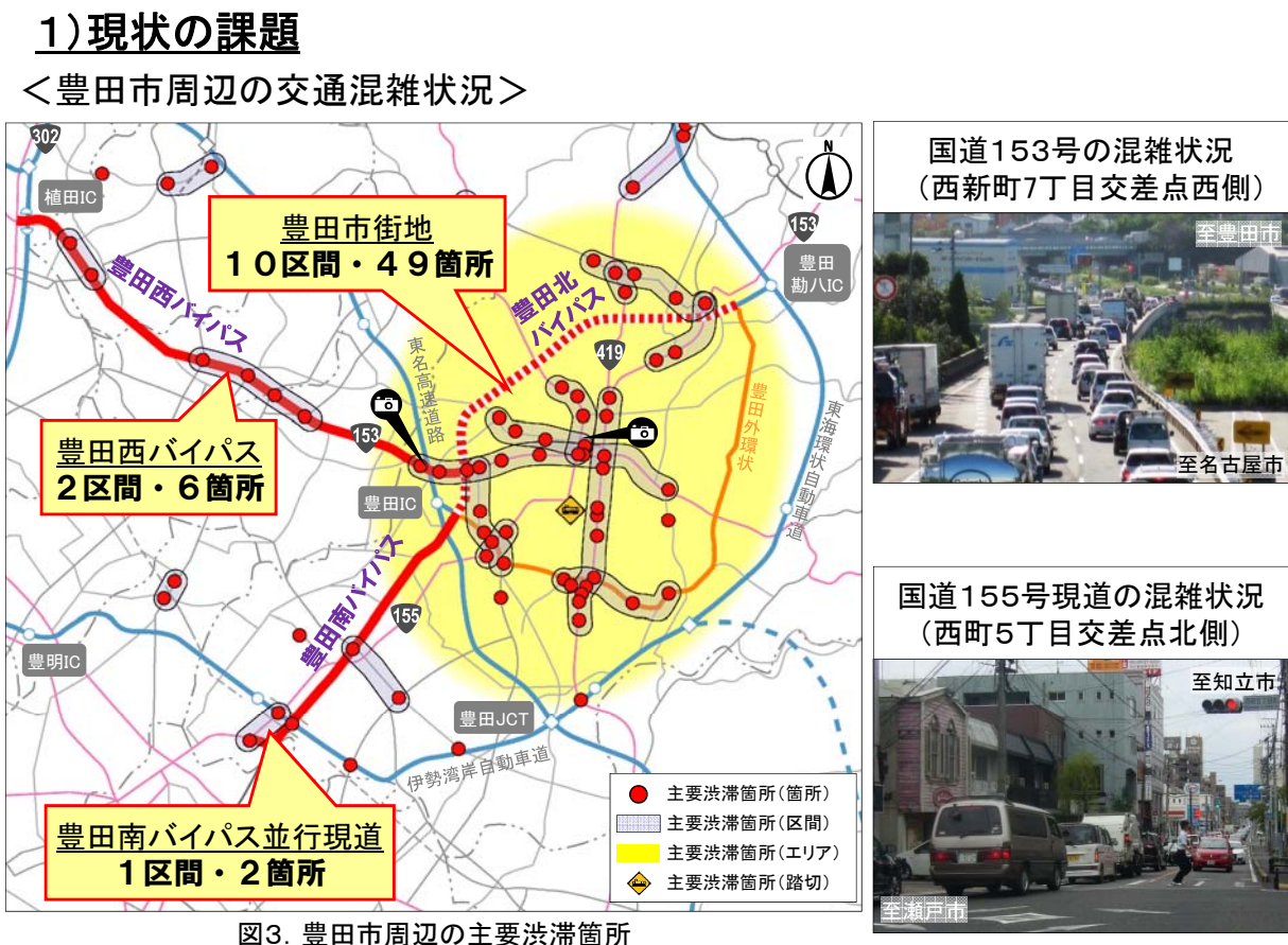
図3. 豊田市周辺の主要渋滞箇所 ※出典:「地域の主要渋滞箇所」(愛知県道路交通渋滞対策推進協議会) ※2「主要渋滞箇所」の箇所数:選定された主要渋滞箇所のうち、交差点等、区間が重なる場合は各々に計上
