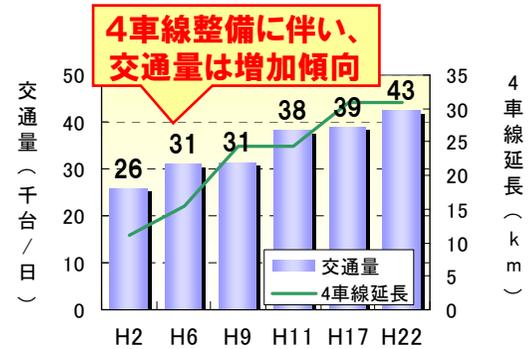
図4 裾野バイパスの4車線整備の状況と交通量の推移
