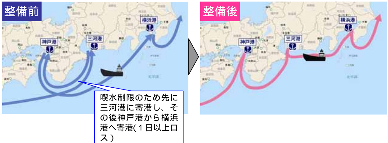
図 2 - 5 喫水制限による寄港順序の変更によるロス時間の削減イメージ
