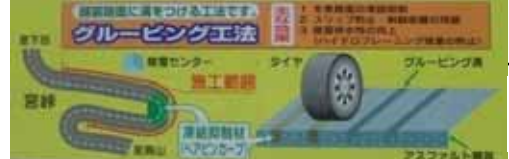
宮峠区間の事故対策の一例 (すべり止め舗装)
