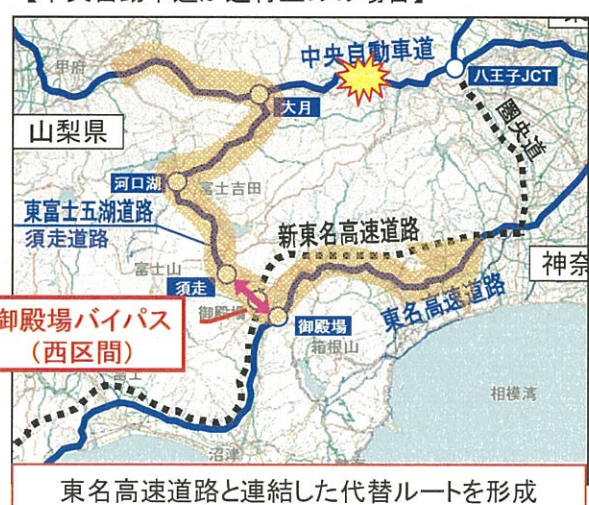
【中央自動車道が通行止めの場合】
