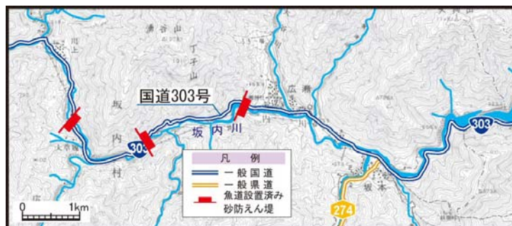
横山ダム上流(坂内川)の魚道の設置状況 (横山ダムから坂内川上流域まで魚類の遡上が可能)
