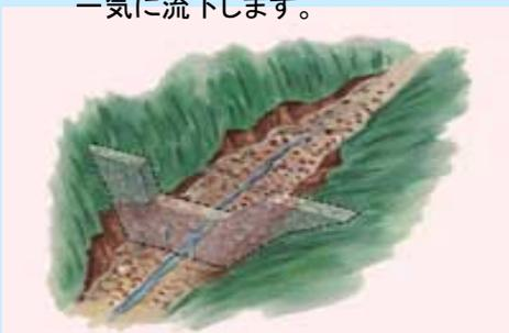
② 砂防堰堤に土砂が貯まると、川の勾配が緩くなり、また河幅が広がるので、土砂を流す水の勢いが弱くなります。
