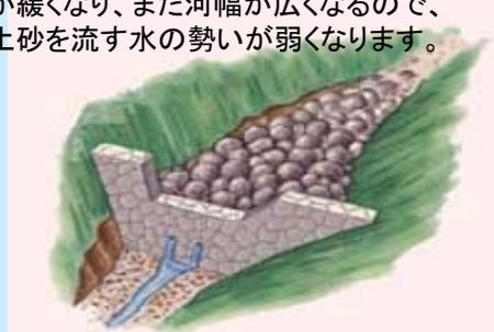
③ 砂防堰堤が土砂で満杯になった後に流れてきた土砂も減勢されて、一部が満杯になった土砂の上に貯まります。
