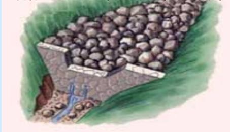
④ 満杯以上に貯まった分の土砂は、その後の川の流れによって徐々に下流に流されていきます(土砂の流出量調整)。また、必要に応じて除石によりさらに容量を確保する場合があります。
