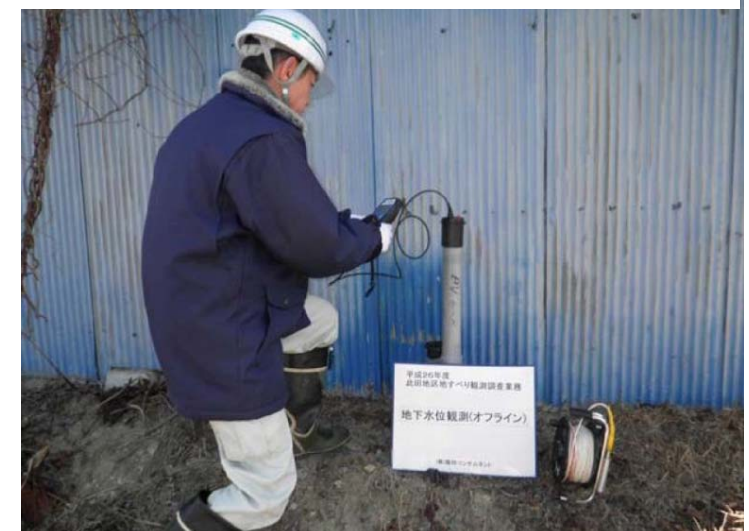
地すべり監視(地下水位計観測)状況
