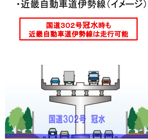
○ 浸水被害発生時の国道302号・近畿自動車道伊勢線 (イメージ)
