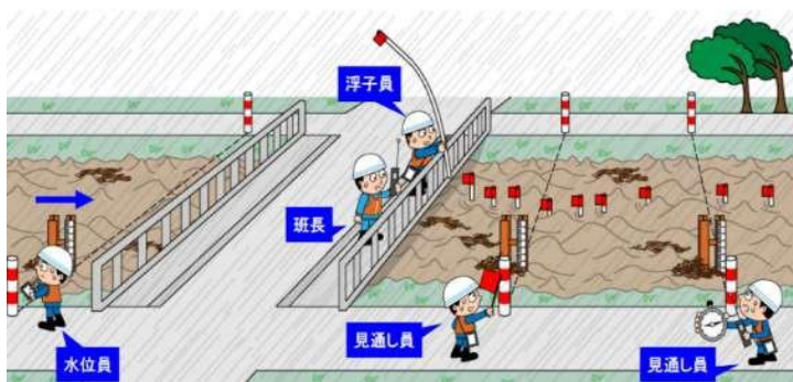
一般的な流量観測の模式図（洪水時）
