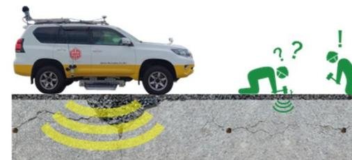
RC床版の土砂化や鉄筋腐食につながる滯水、水平ひびわれといった床版内部の損傷は、外観にあらわれる損傷以上に内部の損傷が著しい場合があります。特に水平ひびわれは、目視・打
