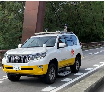
名古屋大学との共同研究により開発した、橋梁のコンクリート床版内部ひびわれや土砂化の損傷を、アスファルト舗装を開削することなく検出するシステムです。路上でのデータ取得は最大時速70kmまで可能で交通規制を必要としません。
