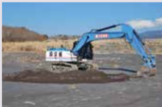
分解組立型(遠隔操作式)バックホウ
