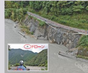
ドローンによる被災状況調査 (静岡市葵区)
