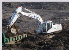
分解型バックホウ(遠隔操縦可能)
