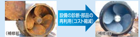
排水機場 ポンプのインペラ修繕の事例
