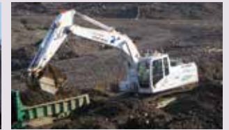
分解型バックホウ(遠隔操縦可能)
