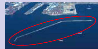
粘り強い構造の防波堤(清水港)
