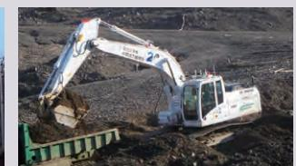
分解型バックホウ(遠隔操縦可能)
