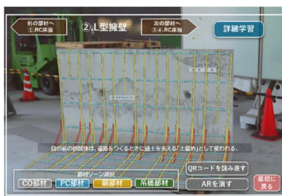
写真-2 鉄筋の可視化
