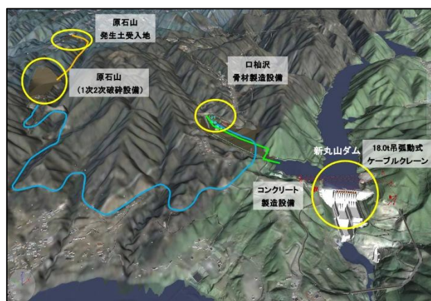
図2-2 ダム本体工事全体配置図
