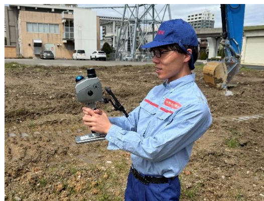
図-7 LiDAR スキャナによる点群取得例
