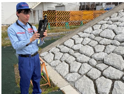
図-6 モバイル GNSS 測量機による点群取得例
