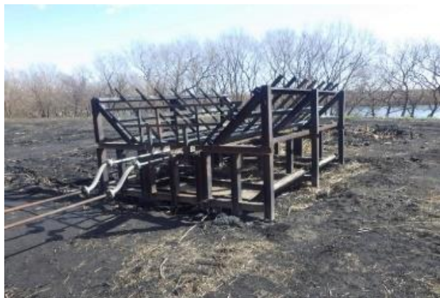
写真-1 酸素供給型高速焼却装置・モヤッシー
