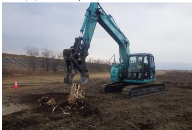
写真-2 バックホウ0.45m 3 （小割専用アタッチメント付き）
