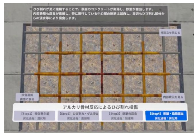
図-4 アルカリ骨材による鉄筋内部の腐食の様子
