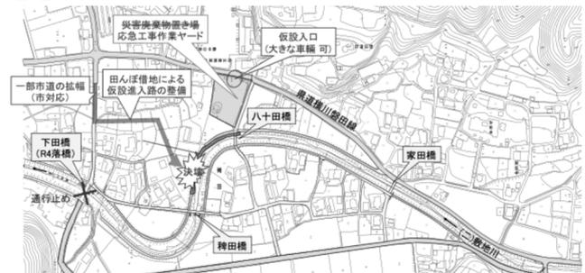
図-7 被災箇所への進入路と作業ヤード
