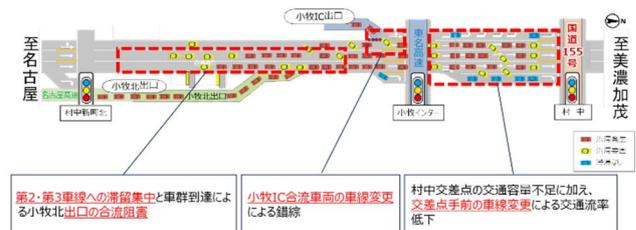
図-9 車線別での速度低下要因
