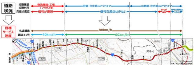
図-7 道路状況に応じたサービスレベルの設定
