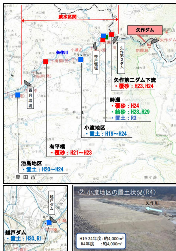
図-8 土砂還元（供給）実験の実施状況 2)
