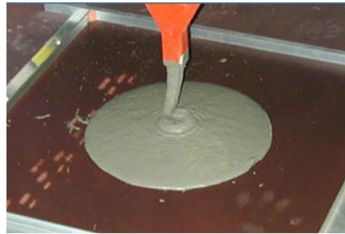
図-6 フロー試験状況
