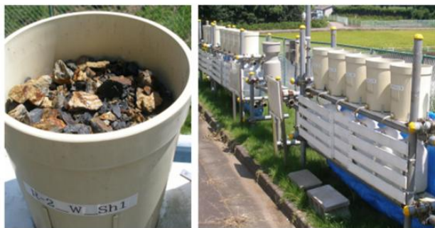
写真-1 土研式雨水曝露試験実施例
