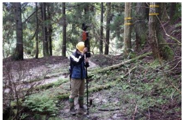
図5 3Dレーザースキャナーでのデータ取得(計測)状況
