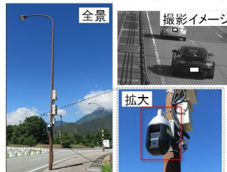
図-2 AIカメラの設置状況と撮影イメージ
