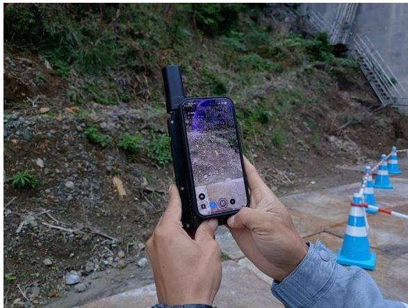
図-7 点群計測を行うモバイル端末
