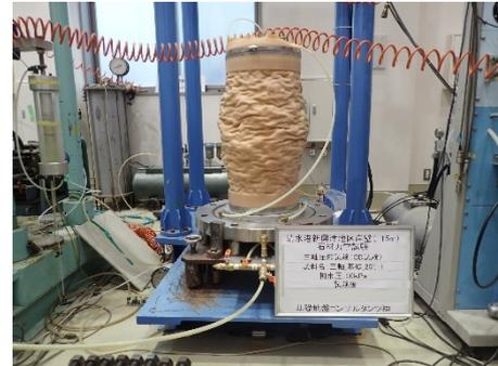
写真-3 大型三軸圧縮試験
