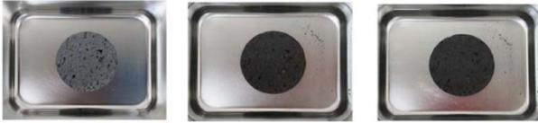
写真-4 スレーキング試験(孔質玄武岩)
