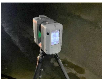
写真-2 3D スキャナ (3次元レーザー)
