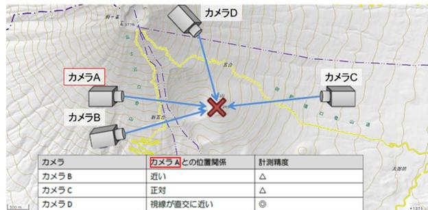
図-4 手法2による座標推定のイメージ
