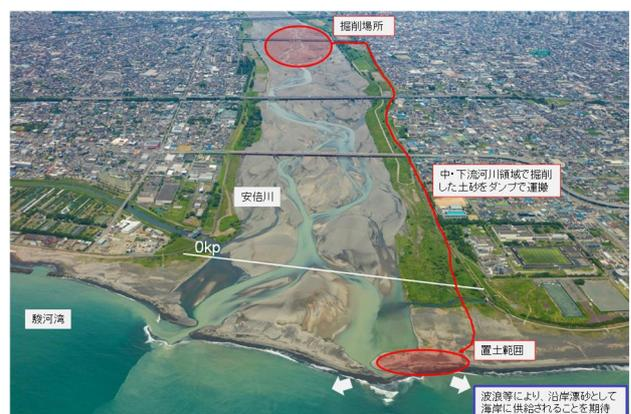
図-7 河口部への置き土のイメージ
