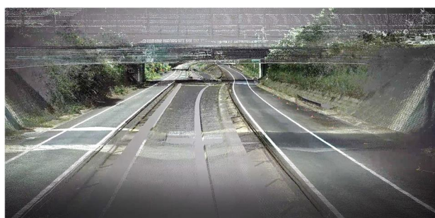
図-3 車載写真レーザ測量による点群データ
