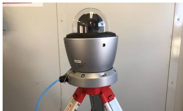
写真-3 全体撮影用固定カメラ
