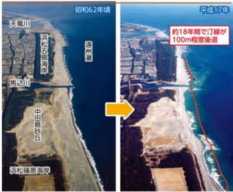
図-3 中田島砂丘が後退している様子
