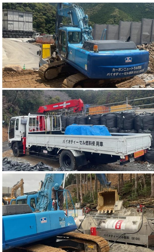
図-4 バイオディーゼル燃料使用車とスマートタンク
