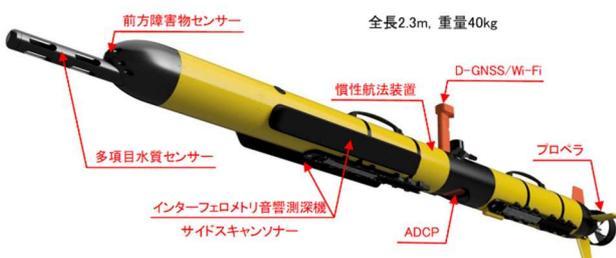
図-3 調査に使用したPMBS搭載のAUV
