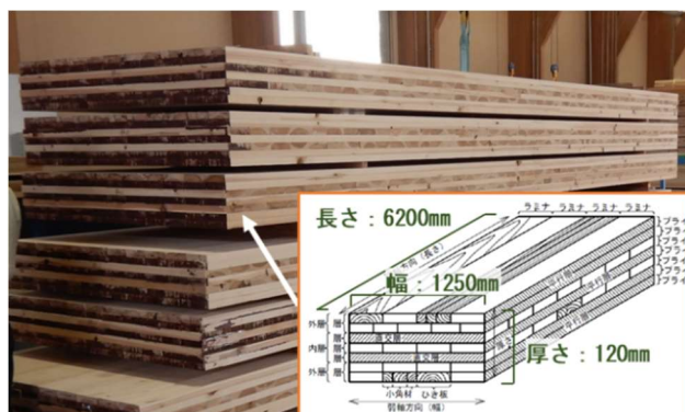
図-1 1) CLTの断面構成
