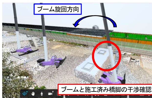
図-11 クレーンブームと施工済み橋脚の干渉
